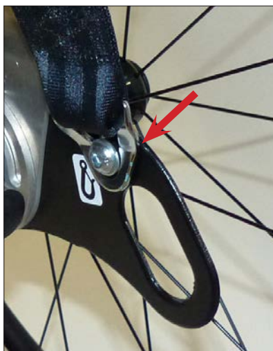
Upevňovací body, zadní, podle ISO 7176-19 pro bezpečnostní pás
